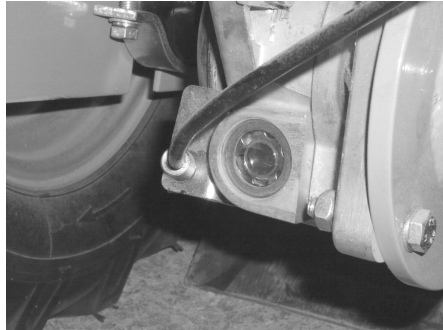
Kontrollöffnung des Differentials
