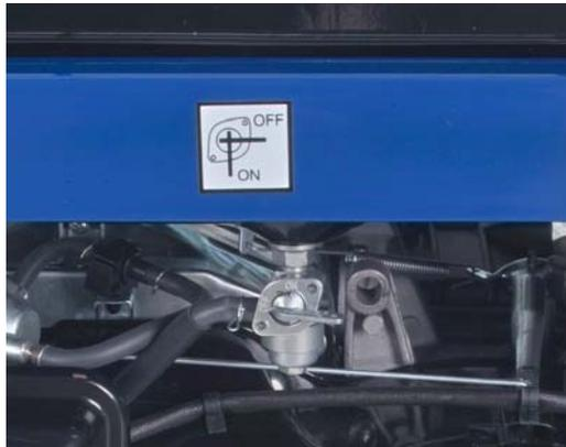
Abb. 4.1: Kraftstoffhahn öffnen / schließen
