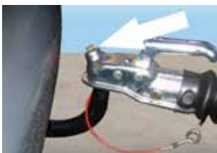
Bild: Kontrollanzeige an der Kugelkupplung
